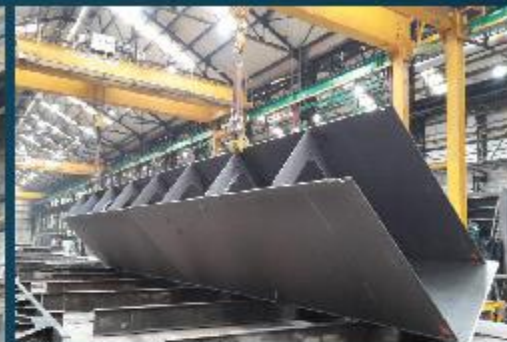
Výroba trámů hlavní v mostárně společnosti Firesta
