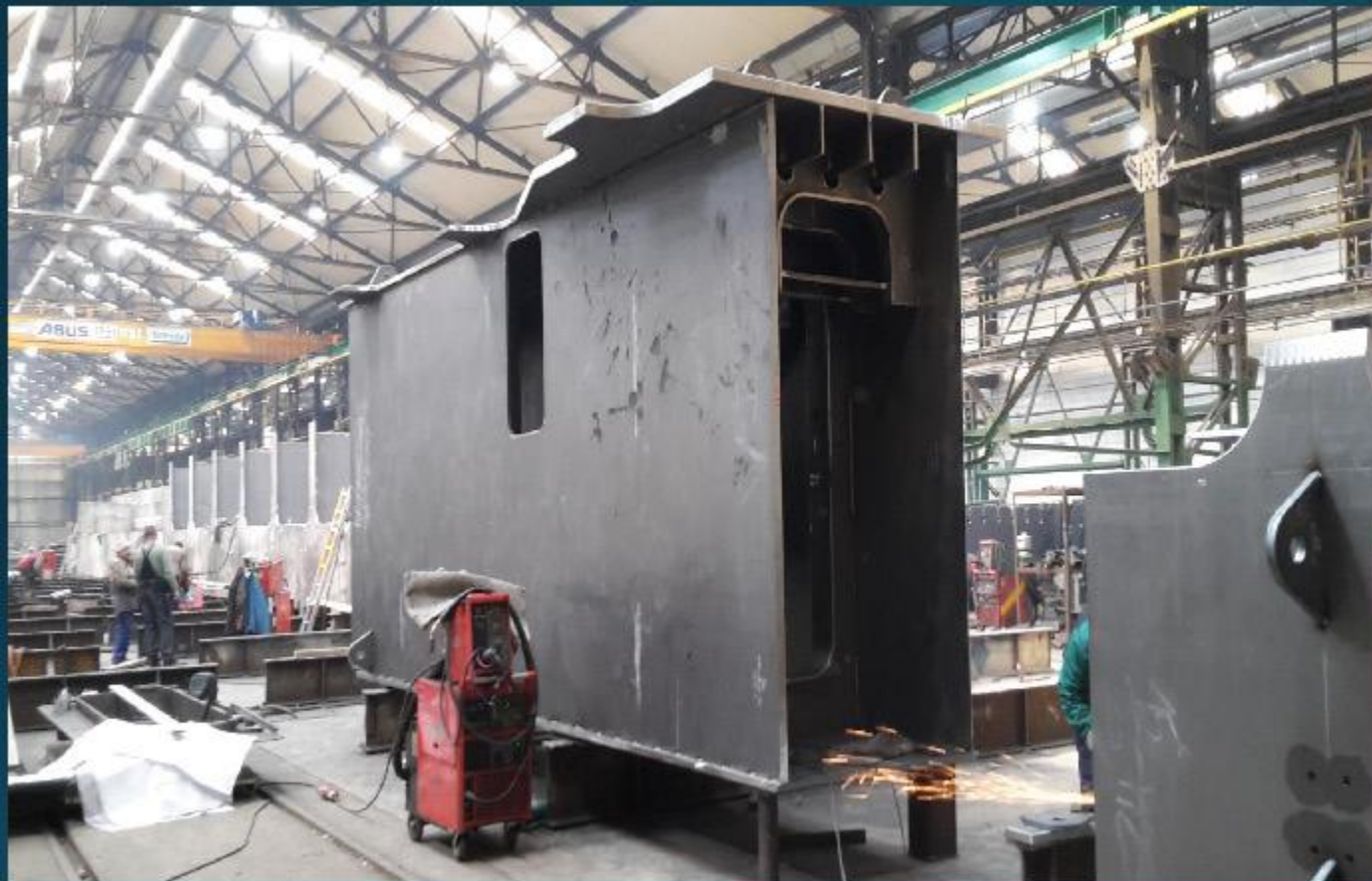
Výroba trámů hlavní v mostárně společnosti Firesta
